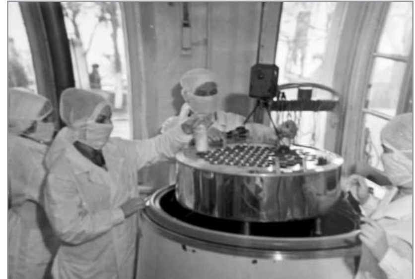
Рисунок 4.91 – Відділ сухої плазми Чернівецької обласної станції переливання крові, 1975 р. Вигруження сухої плазми з апарата для ліофільного висушування донорської плазми Чехословацького виробництва КС-30 (зліва направо: інженер відділу сухої плазми Г. І. Глебов, санітарка З. І. Мікліч, завідувач відділом Н. П. Кобзар)
