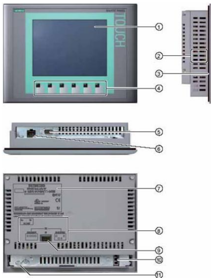
Рисунок 5.3 – Зовнішній вигляд та елементний склад операторської панелі: 1 – дисплей/сенсорний екран; 2 – вирізи для затискних скоб; 3 – монтажне ущільнення; 4 –
