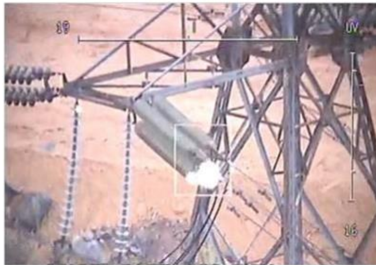
Рисунок 2 – Фото ЛЕП УФ камерою для моніторингу розрядної активності
