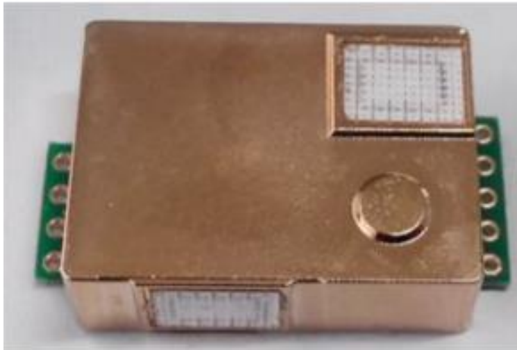
Рис. 23 – загальний вигляд МН-Z19В
