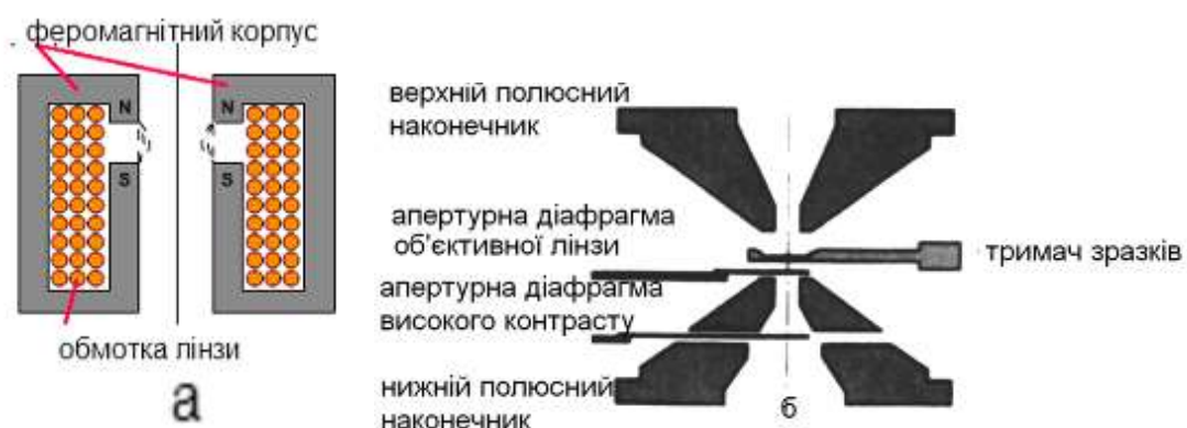
Рис. 11. Електромагнітна лінза без полюсного наконечника (а) та полюсний наконечник (б) [15, 16]
