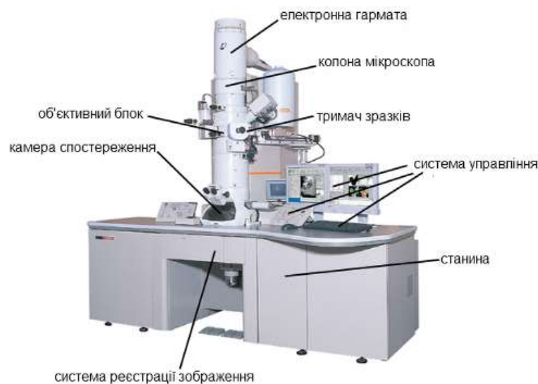
Рис. 9. Основні вузли електронного мікроскопу [14]
