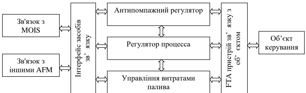
Рисунок 2.1- Блок – схема функціональних зв'язків модуля
