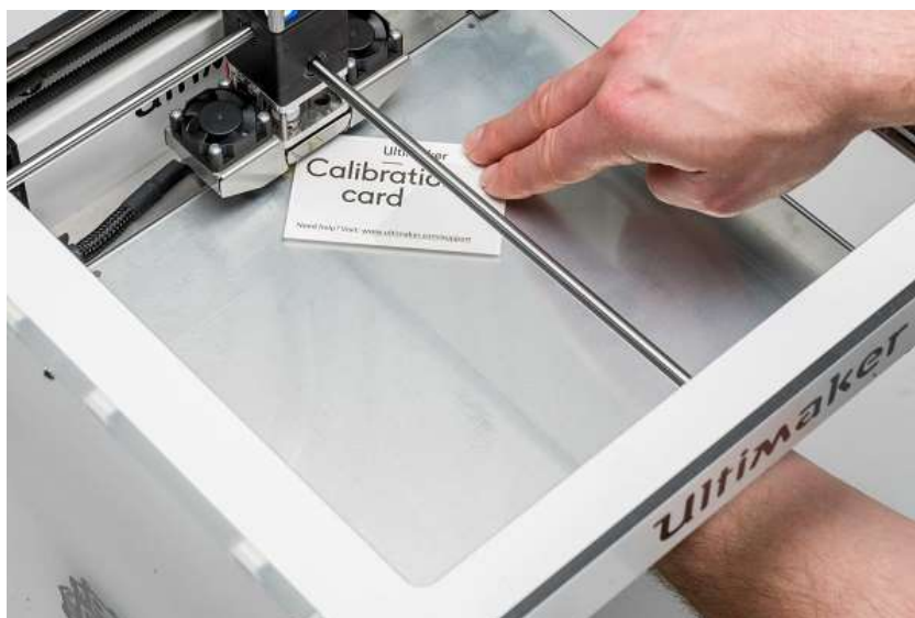
Рис.16 Калібрування принтеру перед початком друку
