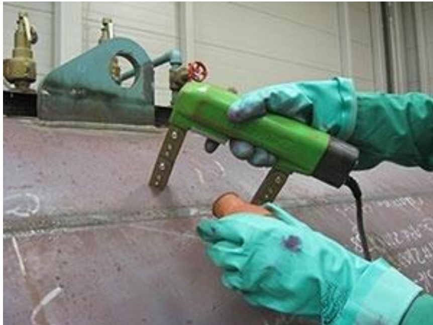
Рисунок 3.8 Принцип праці магнітних дефектоскопів
