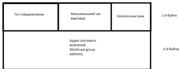
Рис. 1.1 – структура повідомлення протоколу IGMP [3]
