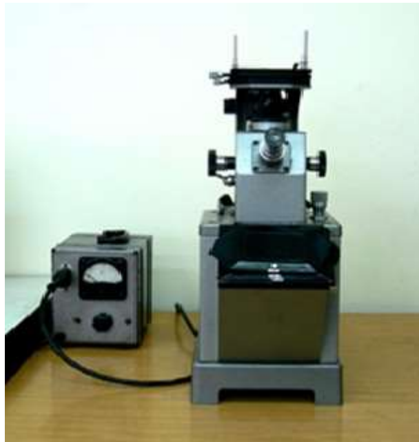
Рисунок 3.1 – Металографічний мікроскоп МИМ-7 (фото)
