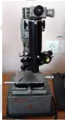
Рисунок 3.4 – Мікротвердомір ПМТ-3 (фото)
