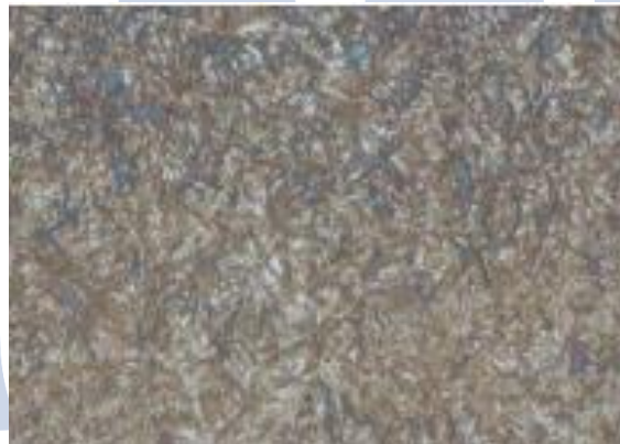
Рисунок 5.4—Структура сталі 40Х після СВЧ та низького відпуску (мартенсит відпуску), \times 500
