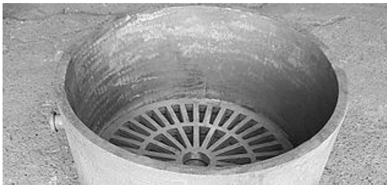
Рисунок 5.6 – Пристосування для завантаження деталей в піч
