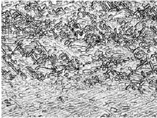
Рисунок 5.3 – Мікроструктура сплаву ВТ23 після гартування (x1000)
