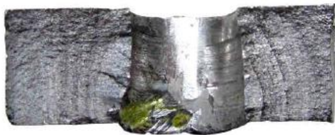
Рис. 1.4 – Злам нижнього пояса лонжерона [3]
