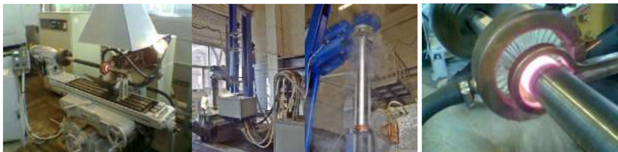
Рисунок 5.4 - Поверхнєве гартування валів струмами високої частоти [6]
