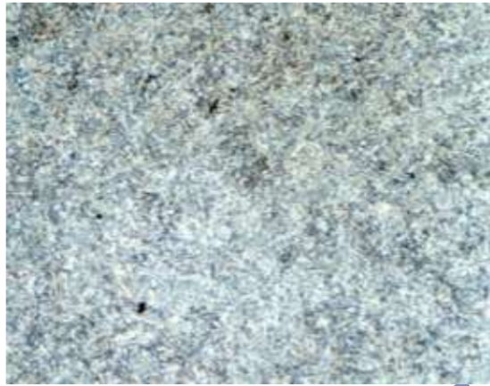
Рисунок 5.3 - Мікроструктура сталі 40X після термополіпшення, x250
