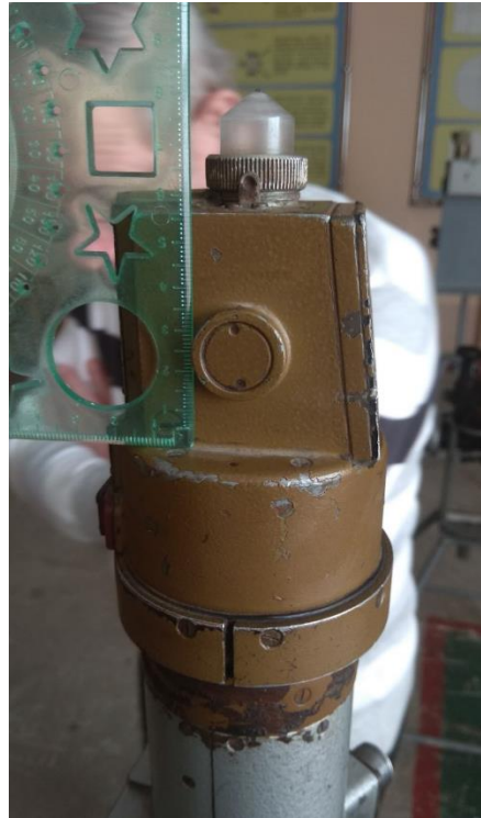
Рисунок 3.4 – Зняття розмірів панорами приціла
