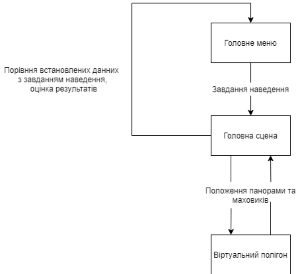
Рисунок 3.3 – Взаємодія між частинами тренажера
