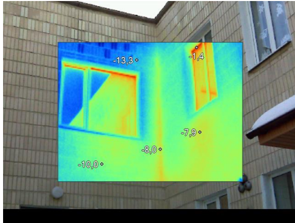
Рисунок 2.14 – Термограма прилягання віконної рами
