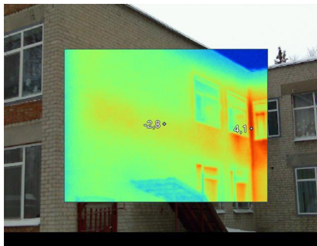
Рисунок Д.2 – Термограма кутових з'єднань стін
