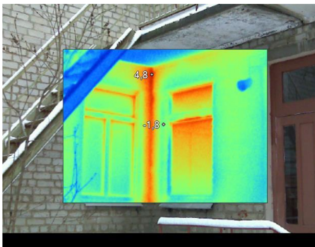
Рисунок Д.2 – Термограма кутових з'єднань стін
