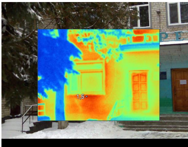
Рисунок Д.6 – Термограма впливу руйнацій на стіну, розташування приладів опалення
