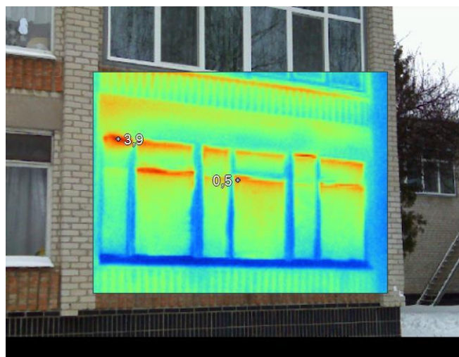
Рисунок Д.3 – Термограма застарілих конструкцій дерев'яних вікон
