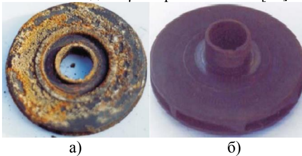
Рисунок 4.20 – Зовнішній вигляд робочих колес до (а) та після (б) гідродинамічного кавітаційного очищення (Омельянюк, 2013) [44]
