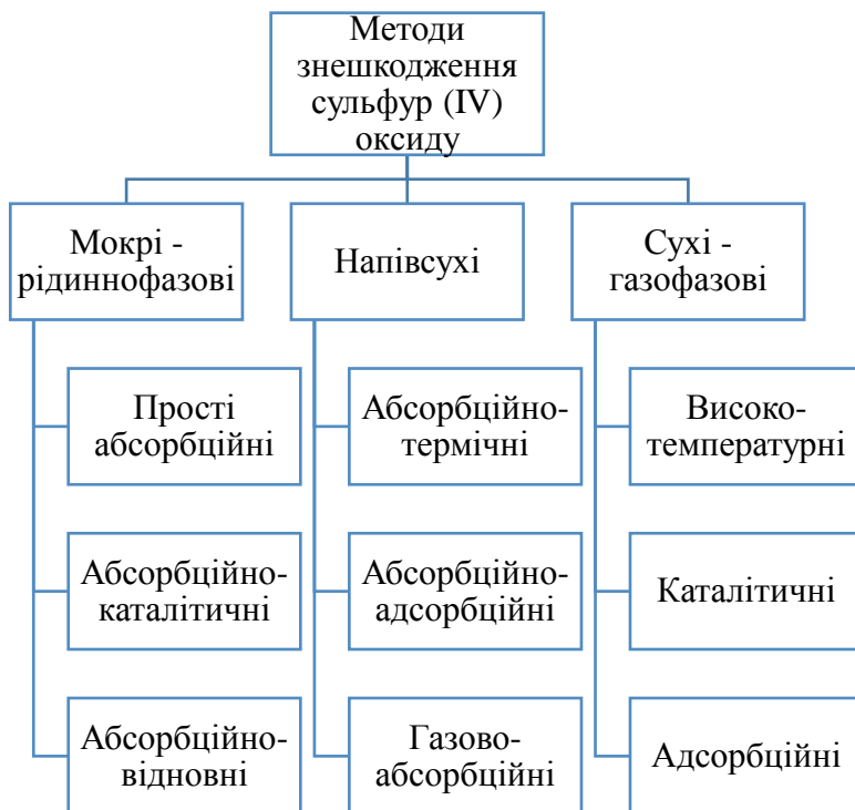
Рисунок 4.6 – Класифікаційна схема процесів десульфуризації відхідних промислових газів
