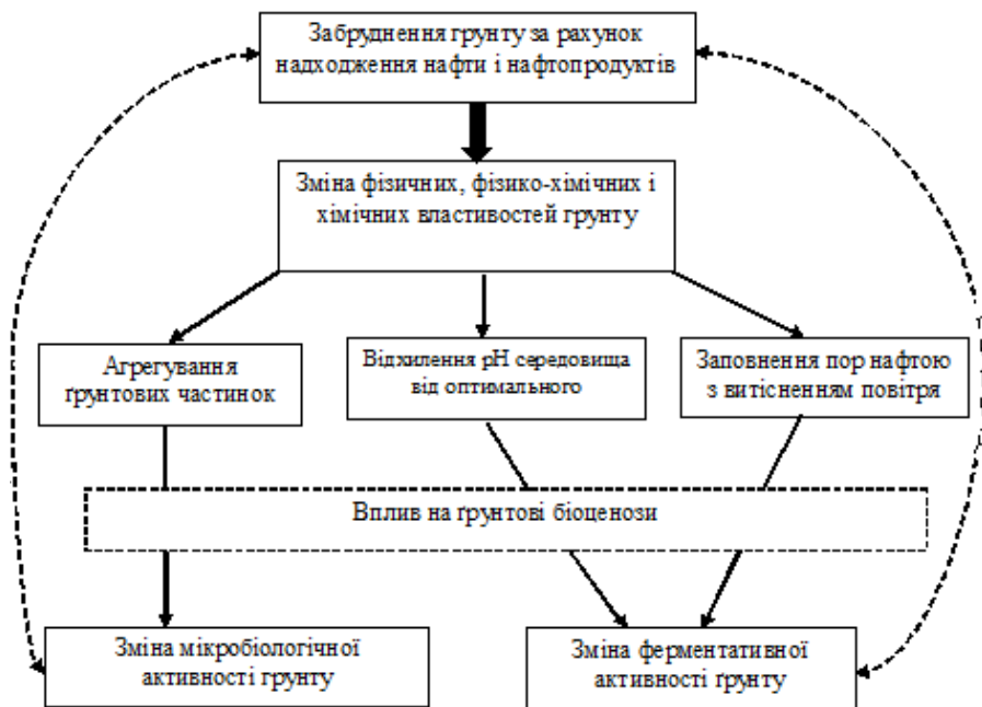
Рисунок 1.13 – Схема причинно-наслідкових зв’язків забруднення ґрунту нафтопродуктами (Аблеева, Пляцук, 2017) [35]
