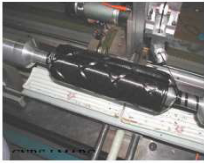
Рисунок 1.5 – Намотувальна машина та 3 можливості намотування
