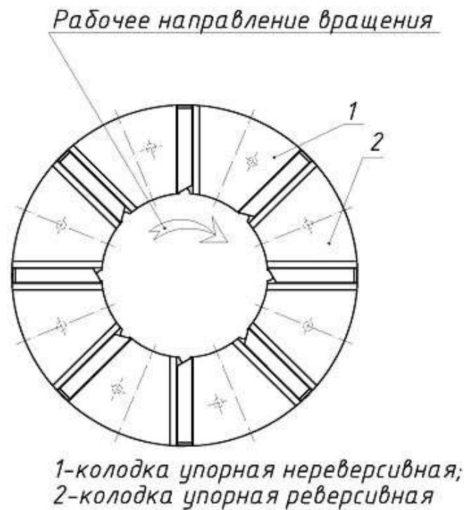
Рисунок 2.8 - Упорний підшипник з реверсивними і нереверсивними колодками
