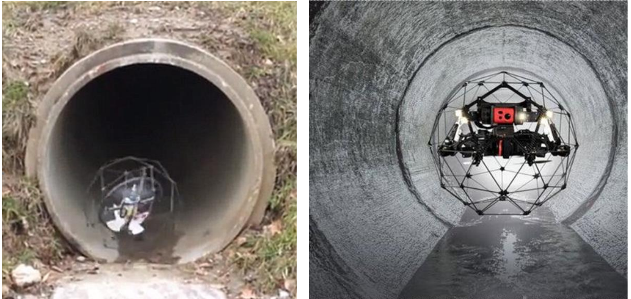
Рисунок 2.18 – Зовнішній вигляд БПЛА для інспекції стічних труб
