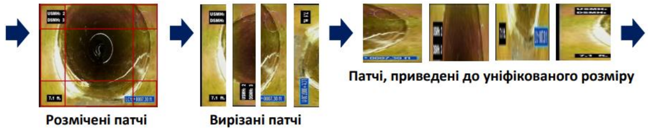
Рисунок 2.21 – Конвеєр обробки розмічених патчів зображення дефектів на крайових ділянках кадрів, для яких відоме значення одометра
