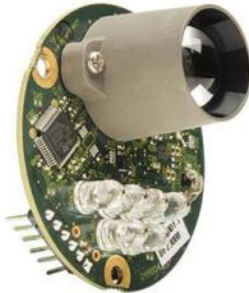
Рисунок 2.9 – Зовнішній вигляд оптичного дальноміру Leddar One Lidar
