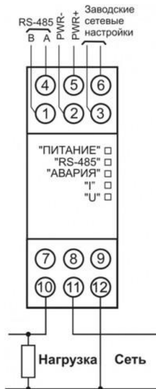
Малюнок 2.5. Підключення пристрою до однофазної мережі
