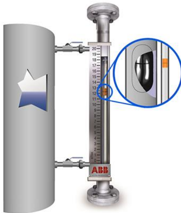
Рис.2.1. Магнітометри рівня використовують магнітно зчеплений човник для визначення положення поплавця в камері[8]
