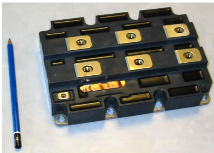
Рис.3.1. Модуль IGBT (IGBT та діоди вільного ходу) з номінальним струмом 1200 А та максимальною напругою 3300 В [18]
