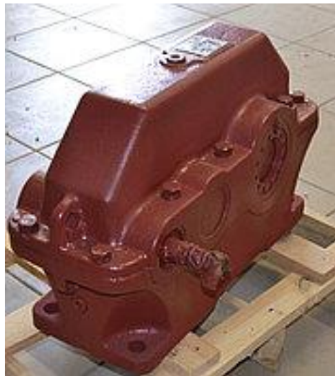
Рисунок 1.2 – Планетарний редуктор компанії «ВНР», модель RB-700
