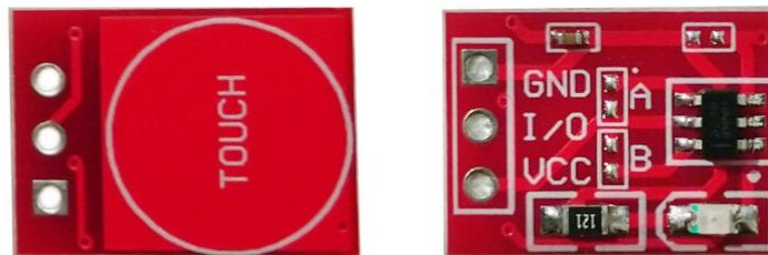
Рис. 2.8. Зовнішній вигляд давача ТТР223 [28]
