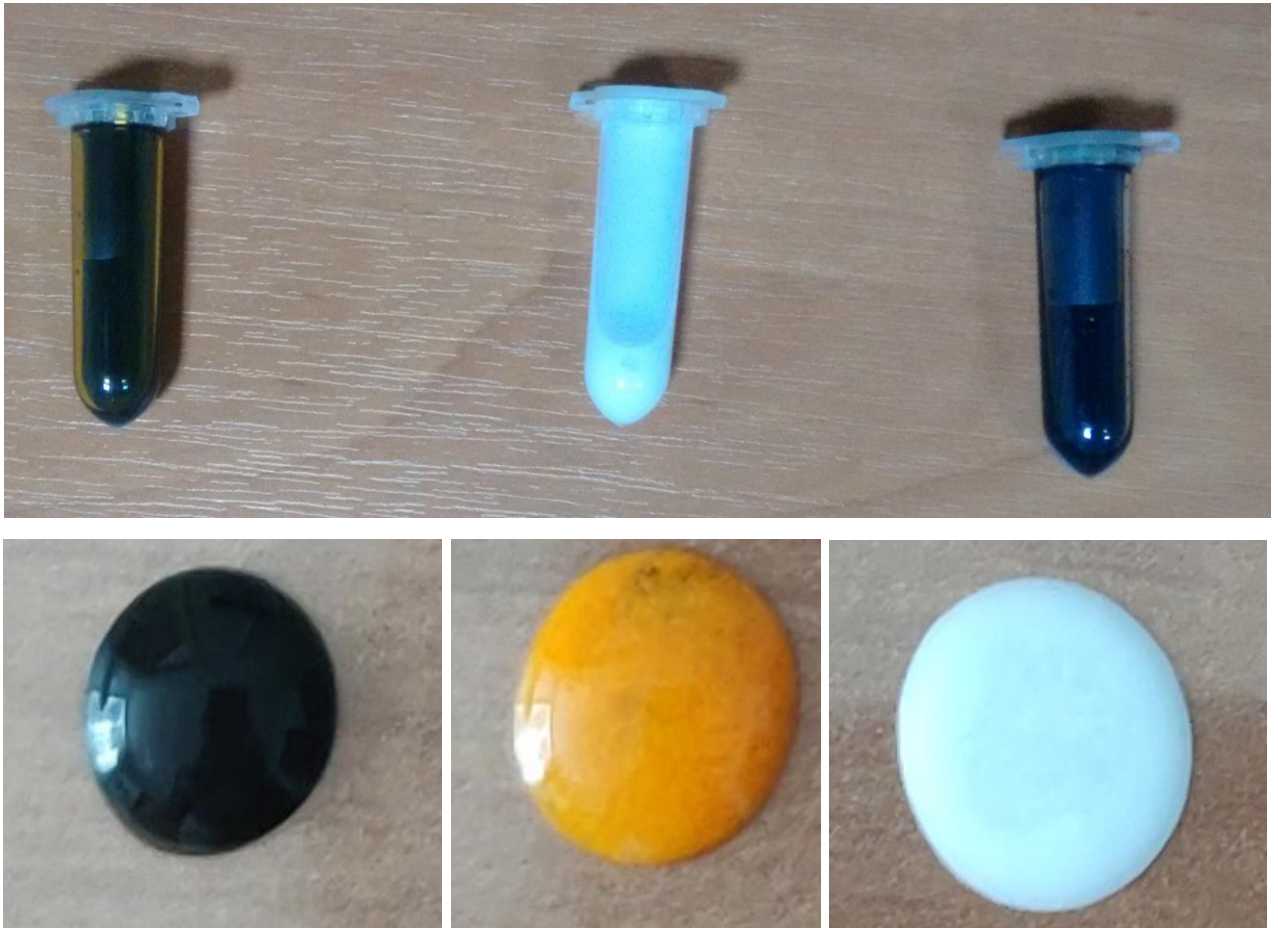
Рисунок 3.4 - Щойно синтезовані НЧ Ag, ZnO і CZTS після заміщення ПАВ та краплі чорнил створені на основі суспензії сполук CZTS, CdS, ZnO у суміші вода-спирт-гліколь-ПВП на скляній підкладці
