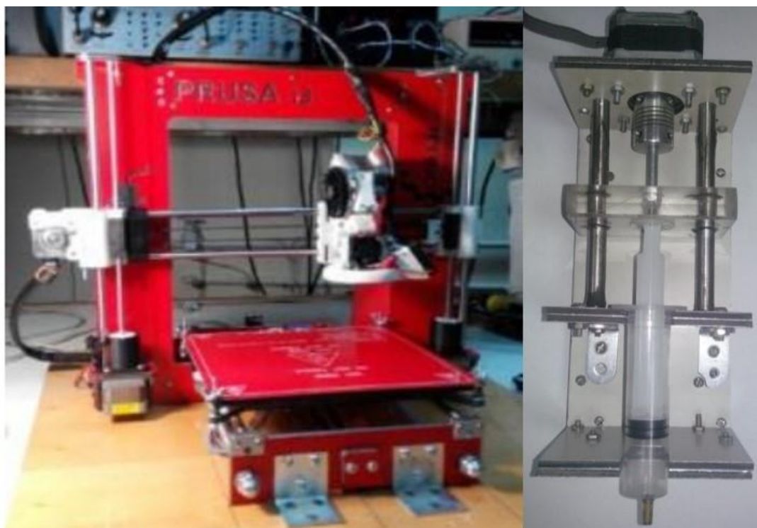
Рисунок 3.6 – 3D принтер та розроблена приставка до нього для друку чорнилами на основі суспензій металічних і напівпровідникових НЧ
