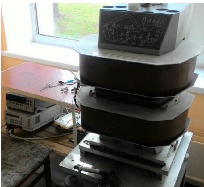
Рисунок 2.10 – Зовнішній вигляд автоматизованого комплексу для дослідження магніторезистивних властивостей
