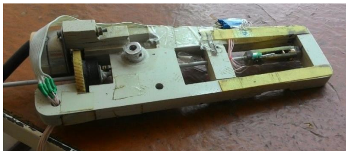
Рисунок 2.11 – Чотирьохконтактний тримач з механізмом повороту
