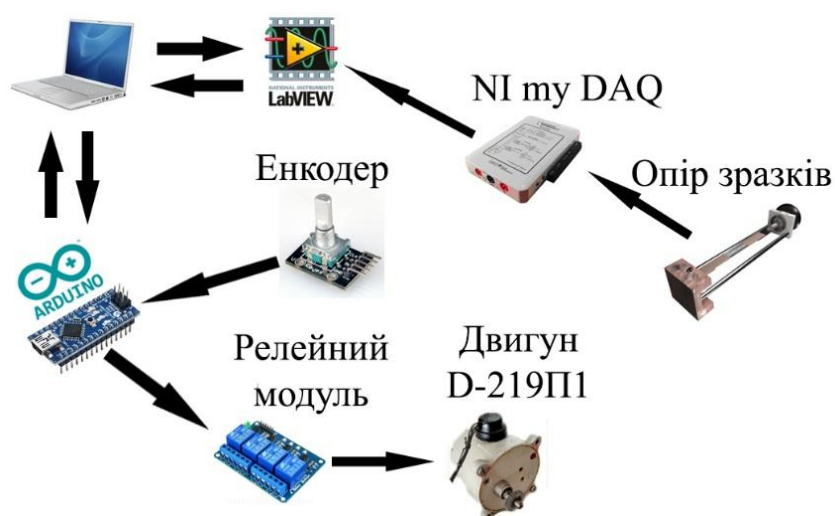
Рисунок 2.5 – Функціональна схема інформаційної система контролю для дослідження тензорезистивних властивостей тонких плівок
