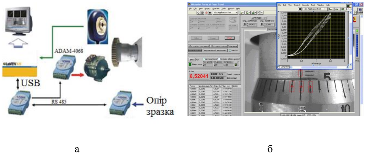
Рисунок 5.6 – Схема автоматизованої системи для вимірювання КТ (а) та інтерфейс програмного забезпечення (б)
