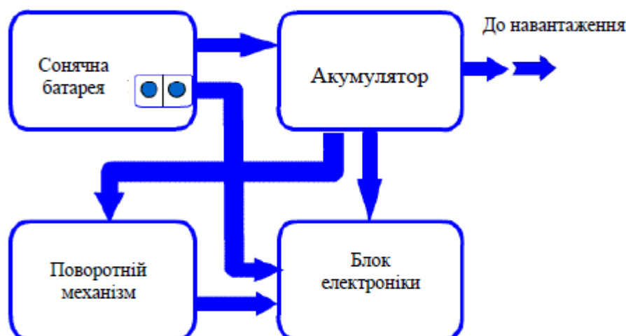
Рисунок 3.9 - Структурна схема системи орієнтації сонячних елементів
