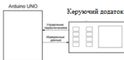
Рис. 18. Логічна структура програмного комплексу мультиметра
