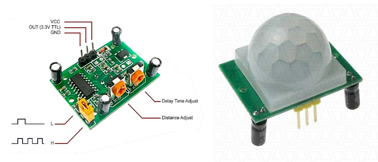
Рисунок 3.4 – Загальний вид датчика руху HC-SR501 (справа) та призначення виводів(зліва).
