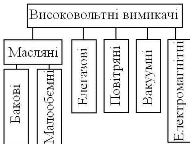
Рисунок 1.1 – Класифікація вимикачів, за способом гасіння дуги
