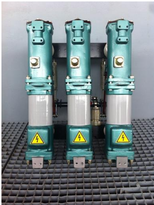
Рисунок 3.2 – зовнішній вигляд вимикача ВМП-10
