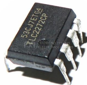
Рисунок 2.6 – Призначення виводів та зовнішній вигляд мікросхеми TLC2272
