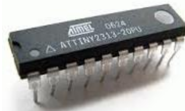
Рисунок 2.4 – Призначення виводів та зовнішній вигляд мікроконтролера ATTINY 2313
