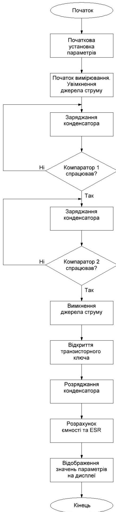
Рисунок 2.1 – Блок-схема алгоритму роботи пристрою вимірювання параметрів конденсаторів
