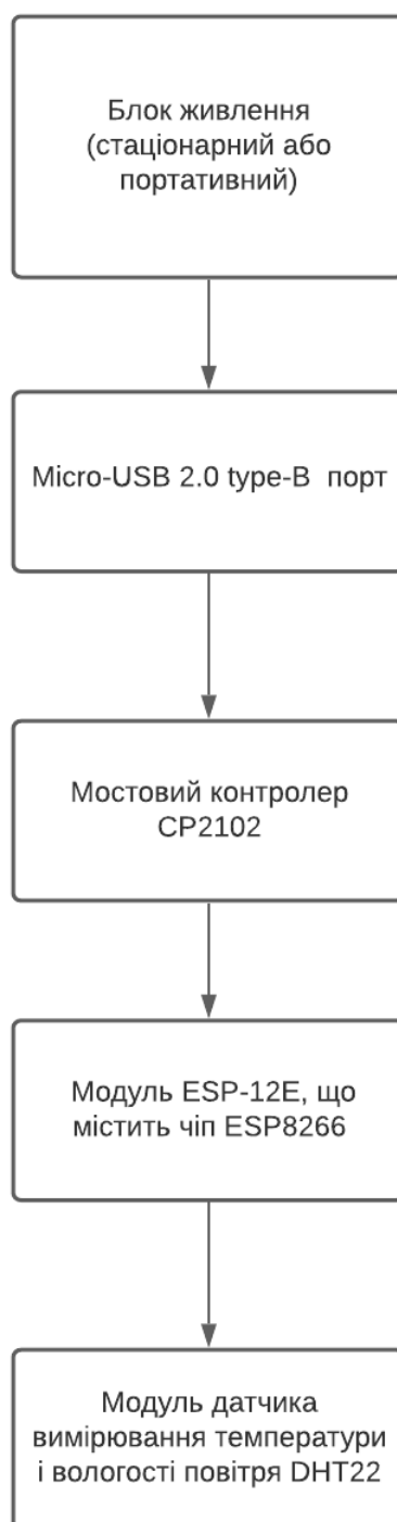
Рисунок 2.2 – Структурна схема вимірювального приладу
