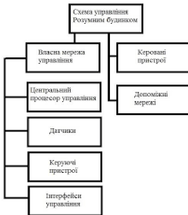
Рис. 5 - Структурна схема управління будинком
