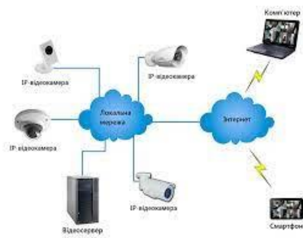
Рис.17 - Схематична схема системи відео нагляду
