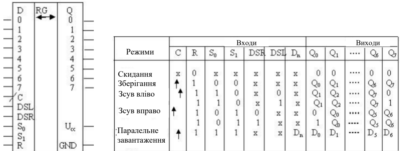
Рисунок 5.5 – Мікросхема SN74ALS198N і таблиця режимів її роботи [7]
