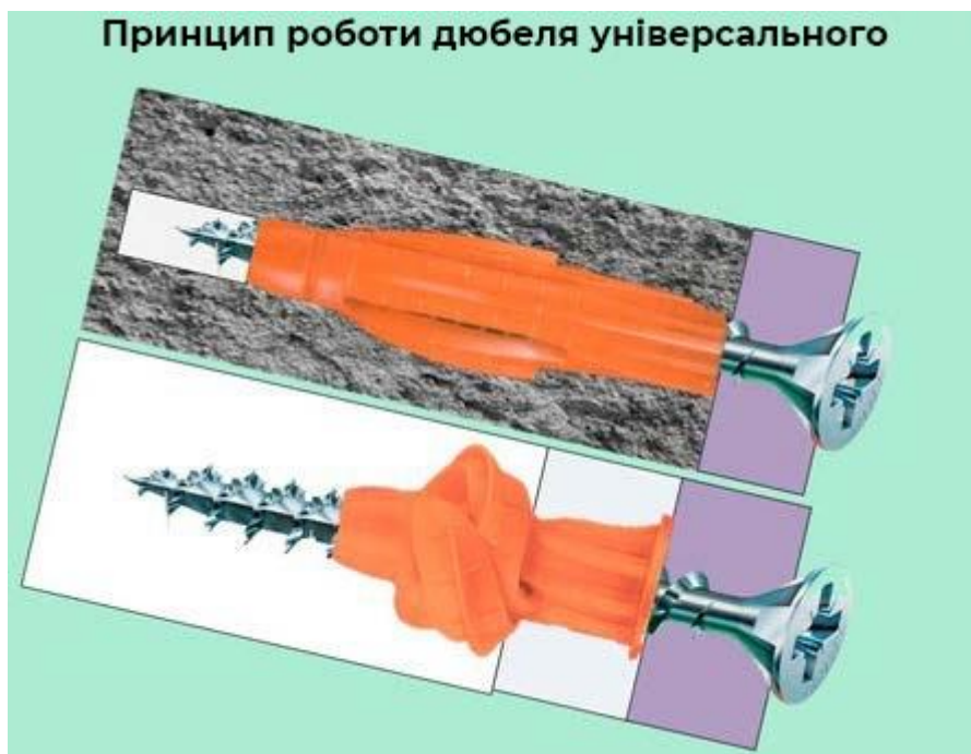
Рисунок 3.10 - Універсальний дюбель
