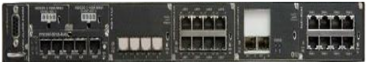
Рисунок 5 - Зовнішній вигляд мультиплексора Ericsson OMS 860
