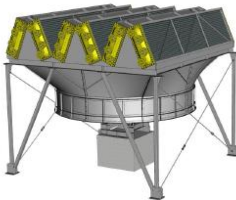
Рисунок 1.5 – Конструкція апарату повітряного охолодження АПЗ
