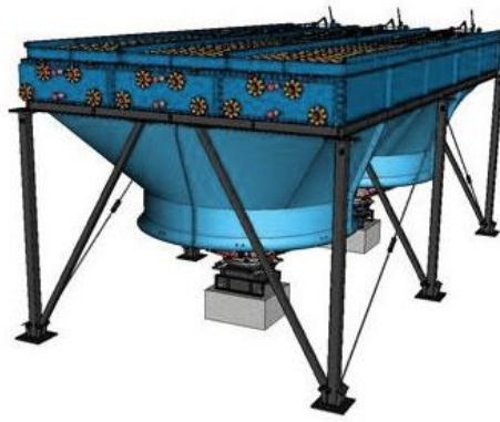
Рисунок 1.6 – Виртуальная модель аппарата воздушного охлаждения горизонтального типа
