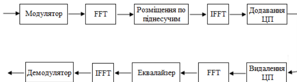
Рисунок 16 – Передача даних за допомогою технології SC-FDMA
