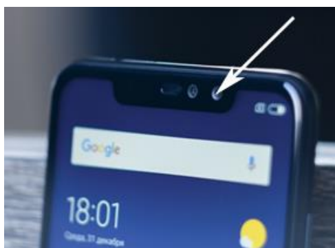
Рисунок 1.1 – Розташування сенсора освітленості над екраном смартфона
