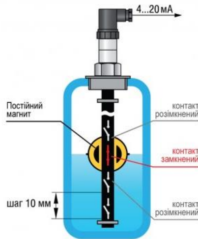
Рисунок 20- Поплавкові датчики ПДУ-И
