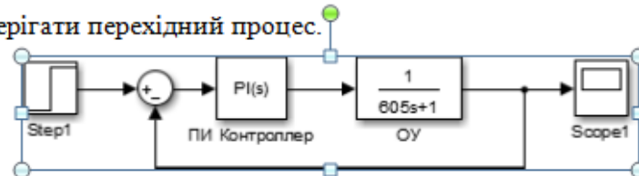
Рисунок 5.8 – Структурна схема об'єкта керування
