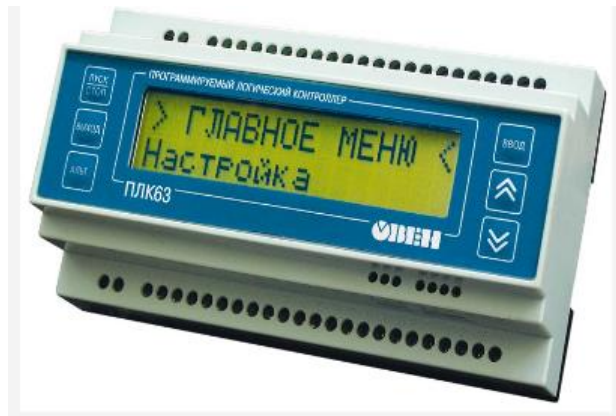
Рисунок 13 - Контролер ОВЕН ПЛК63
