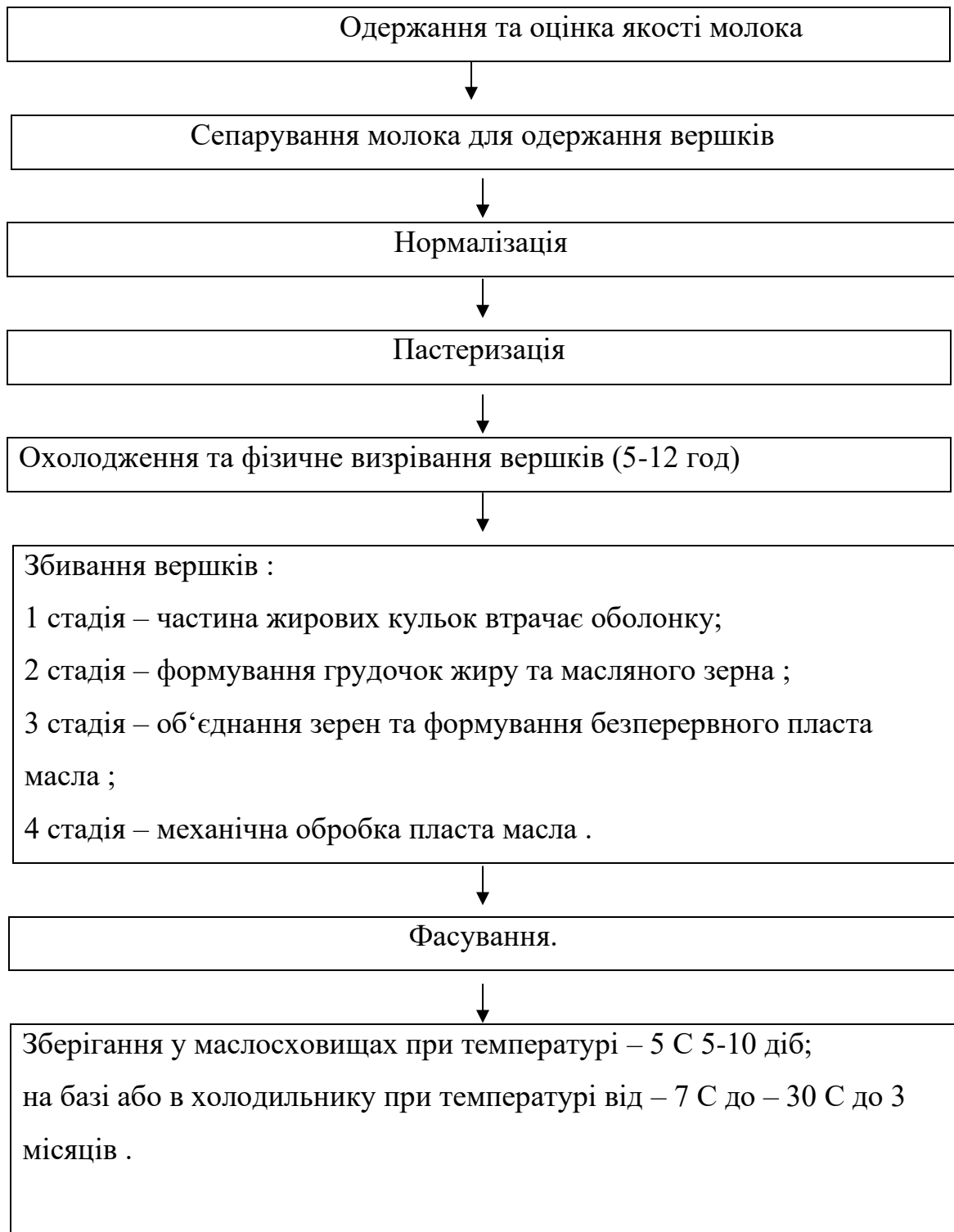
Рис. 2.1 Технологічна схема виробництва масла методом збивання вершків.
