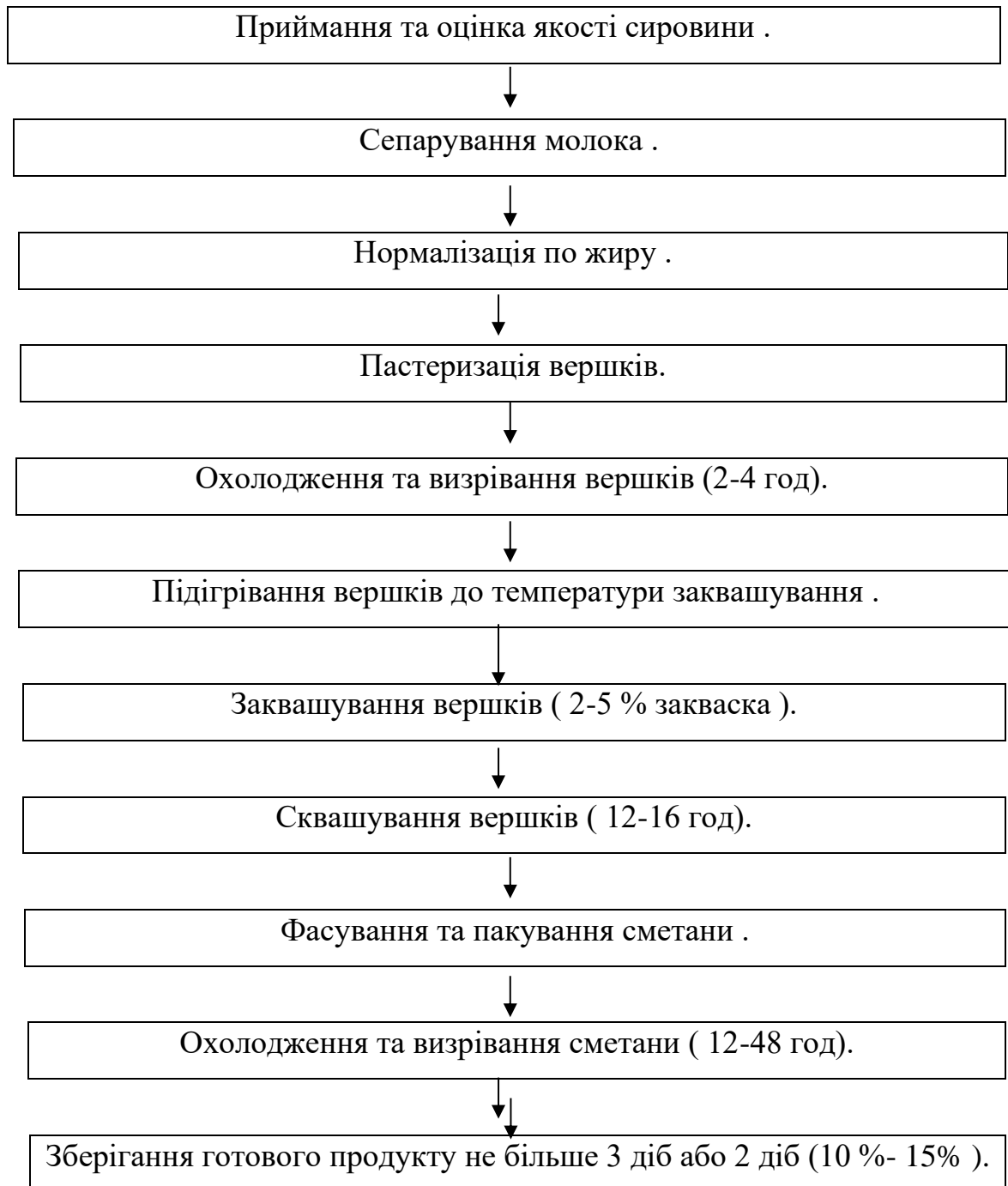
Рис.2.2 Технологічна схема виробництва сметани резервуарним способом .
