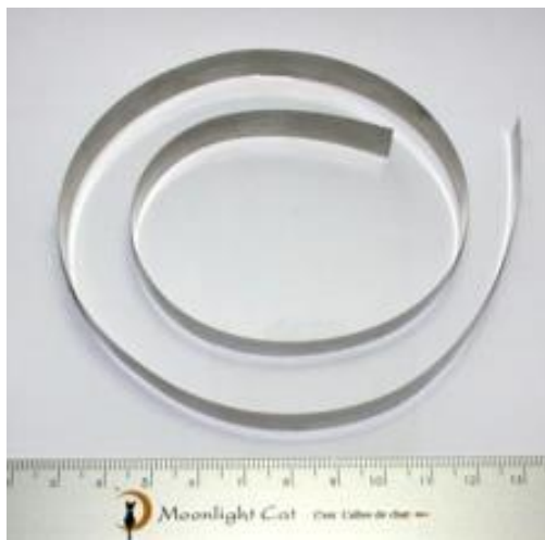
Рисунок 3.1 – Зовнішній вигляд зразка сплаву \text{AlCrFeMnNi} після прокатки до ступеню деформації 4257%. Адаптовано з [25]
