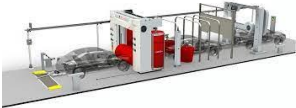
Рисунок 1.4 – Схема тунельної авомийки
