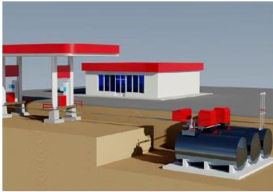
Рисунок 1.1 – Класифікація АЗС за типом розташування резервуарів зберігання палива: 1 – традиційна АЗС, 2 – блокова АЗС
