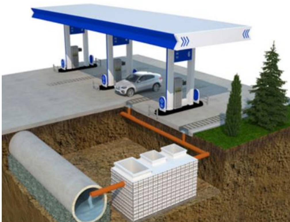
Рисунок 2.3 – Система збору поверхневого стоку на території АЗС
